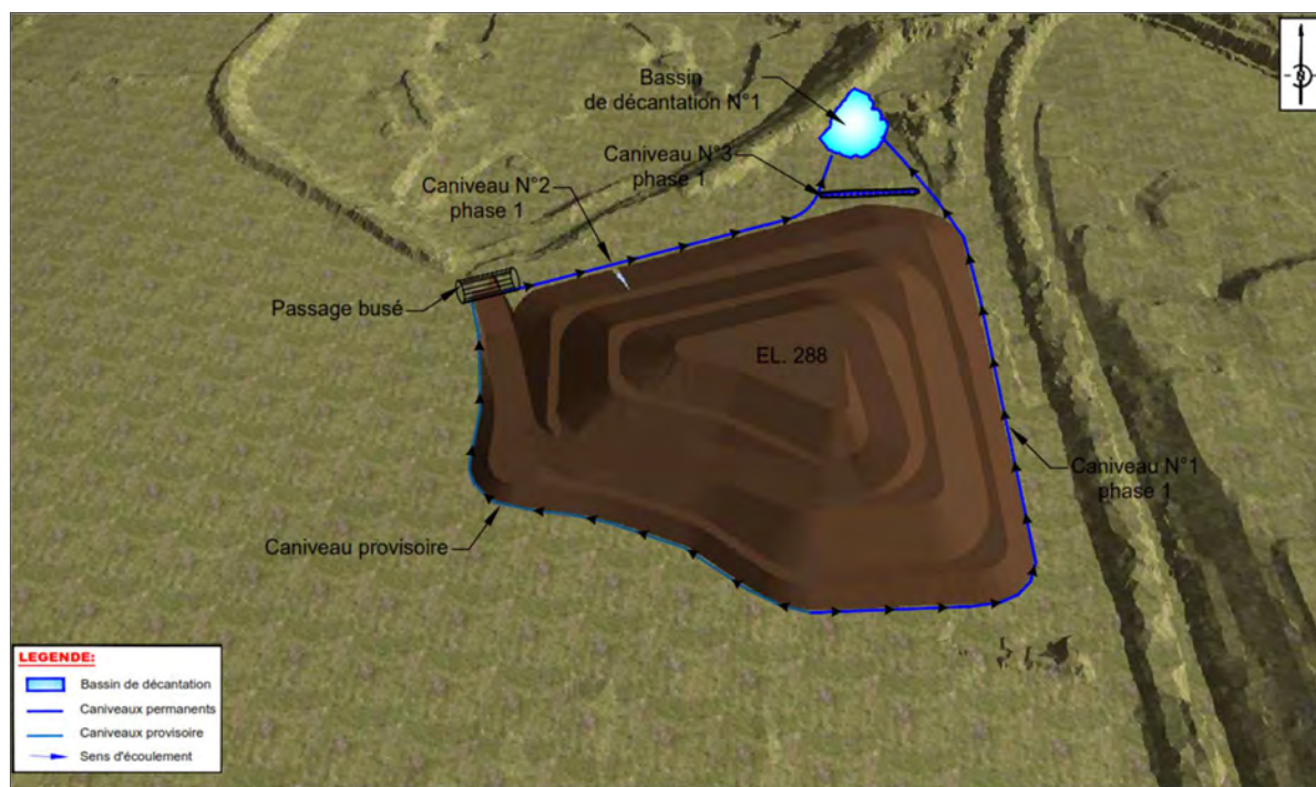
Figure 22 : Principe de gestion des eaux-Phase 1
